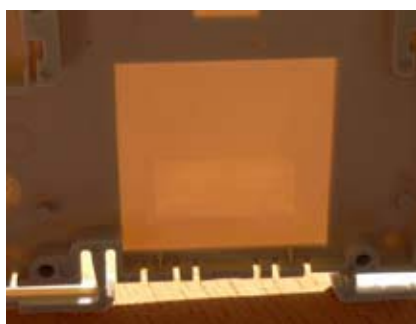
Bild 5: Innerhalb von Lufteinschlüssen in Kavitäten, z. B. durch dünnere Wandstärken, lassen sich Entlüftungseinsätze platzieren, die fast jeder Kontur folgen können. Die Entlüftungsnuten werden konturfolgend eingebracht, was bei den heutigen 3D-Konstruktionen einfach umsetzbar ist
