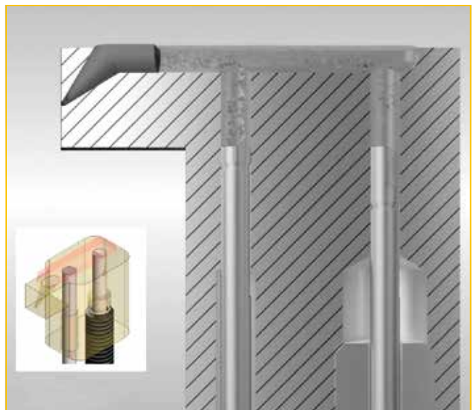
Abb. 4: HeiNo-Überlaufentlüftung (Quelle: Werksbild KB Hein)
