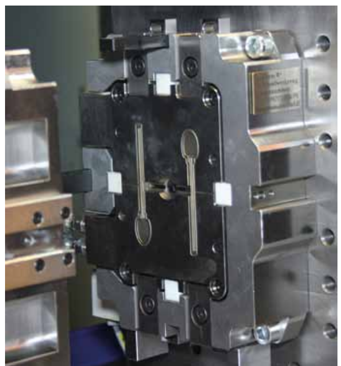
Bild 2: Modulwerkzeug mit wechselbaren Formeinsätzen
